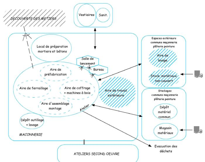
SCHÉMA DÉTAILLÉ DES ESPACES DE MAÇONNERIE - PR'OPTIM 2008
